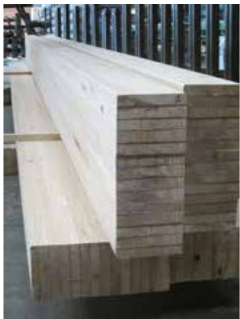
Poutres lamellées-collées en sortie de chaîne de fabrication. GOUBIE SA (24)
